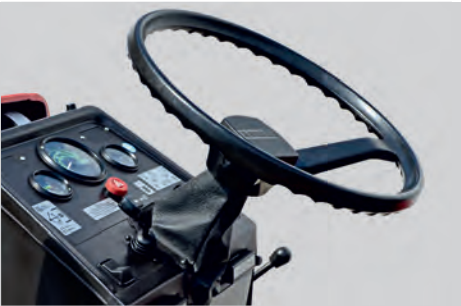
Гидросилитель руля для облегчения управления Power steering for easier control
