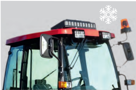
Установка кондиционера Installation of air conditioner
