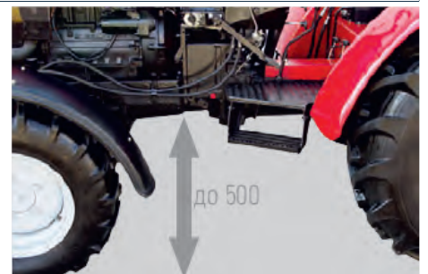
Высокий клиренс и отличная проходимость High ground clearance and excellent overpass
