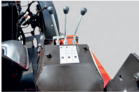
Удобное 3-х секционное управление гидросистемой Comfortable 3-sectional hydraulic system controller
