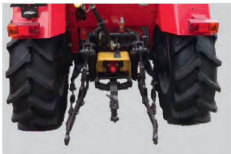
Повышенная грузоподъемность задней навески Increased lifting capacity of the rear hitch
