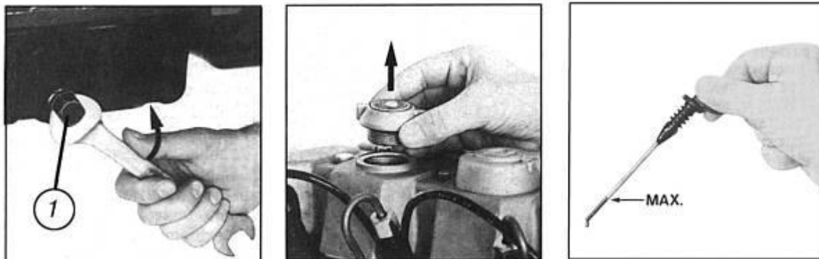
Рисунок 6.4.4 – Замена масла в картере двигателя.
