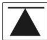
Рисунок 6.6.1 – Знак места установки домкрата
